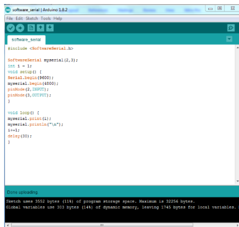
Gambar 11. Kode program pada Arduino uno mengirim data ke WeMos D1 R1
